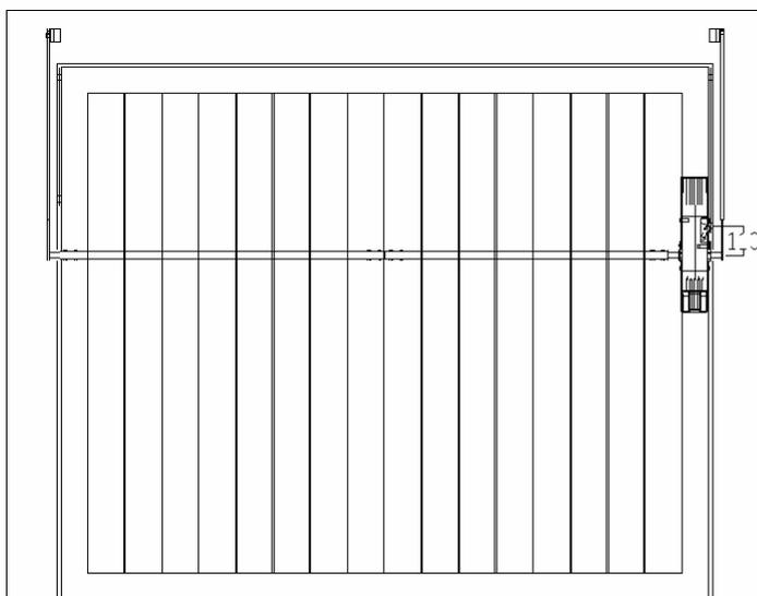
Motor instalado en el centro con dos brazos
