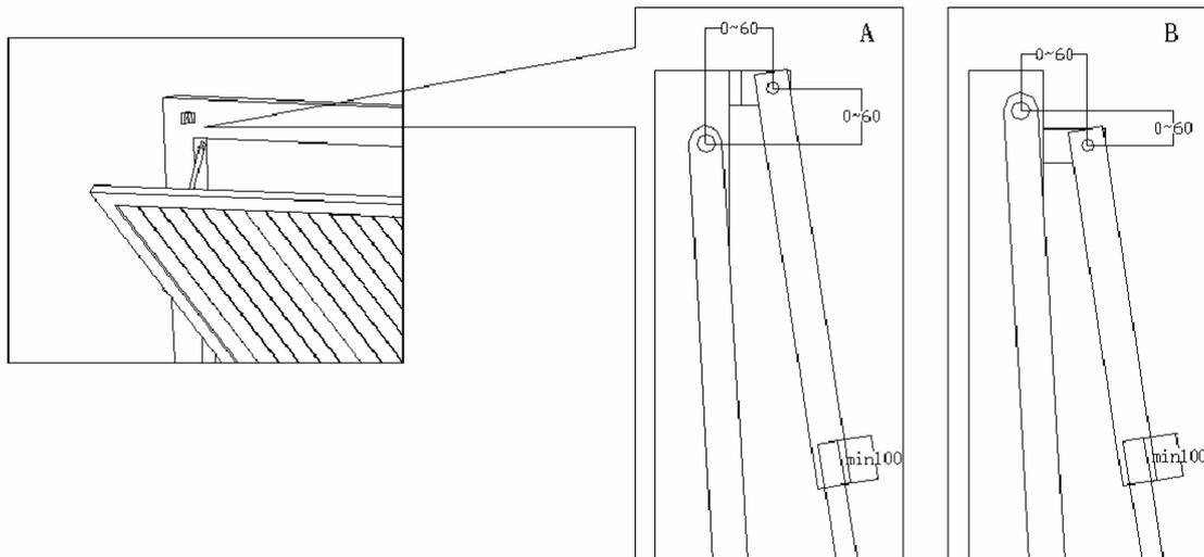
Motor instalado en lateral con dos brazos
